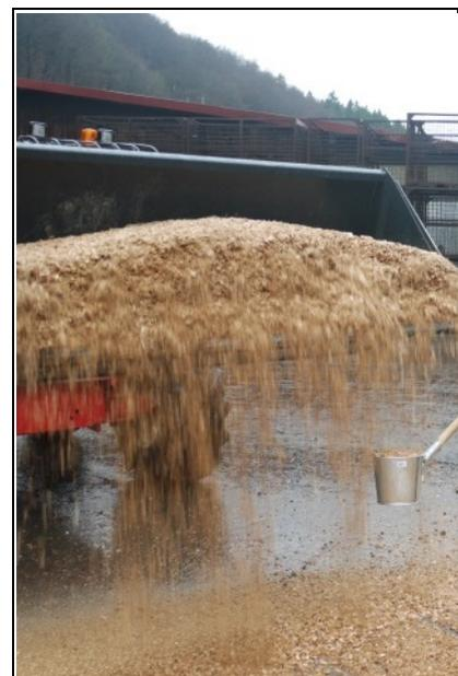
**Abb. 8: Probenahme mit einem Probensammler mit Stiel beim Abkippen einer Radladerschaufel**
