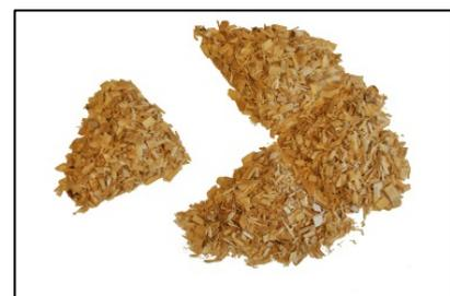
Abb. 11: Entnahme der Analysenprobe als Viertelprobe
